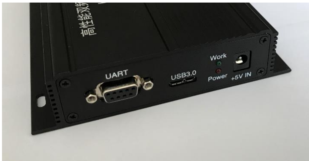
图 2 HG-SOFTGPS06-S 采集器前面板
