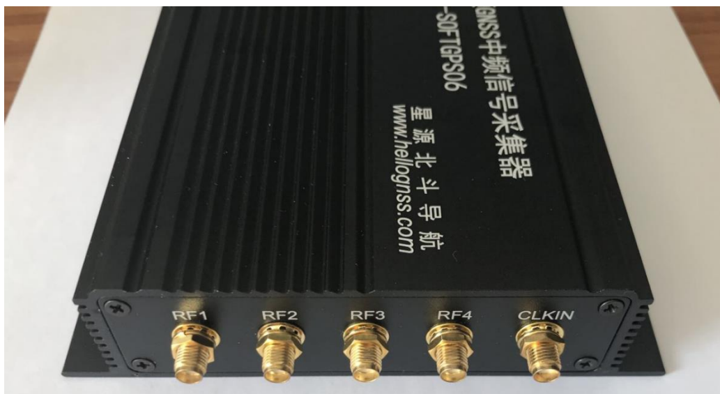
图 3 HG-SOFTGPS06-S 采集器后面板
