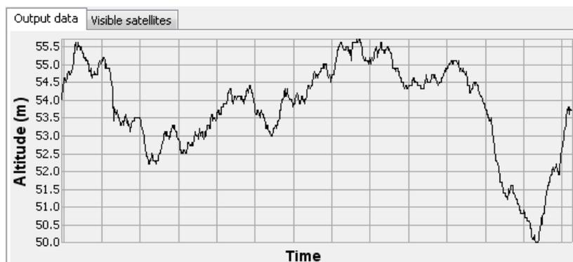
图 8 HG-ARMGPS V1.3 定位高度曲线
