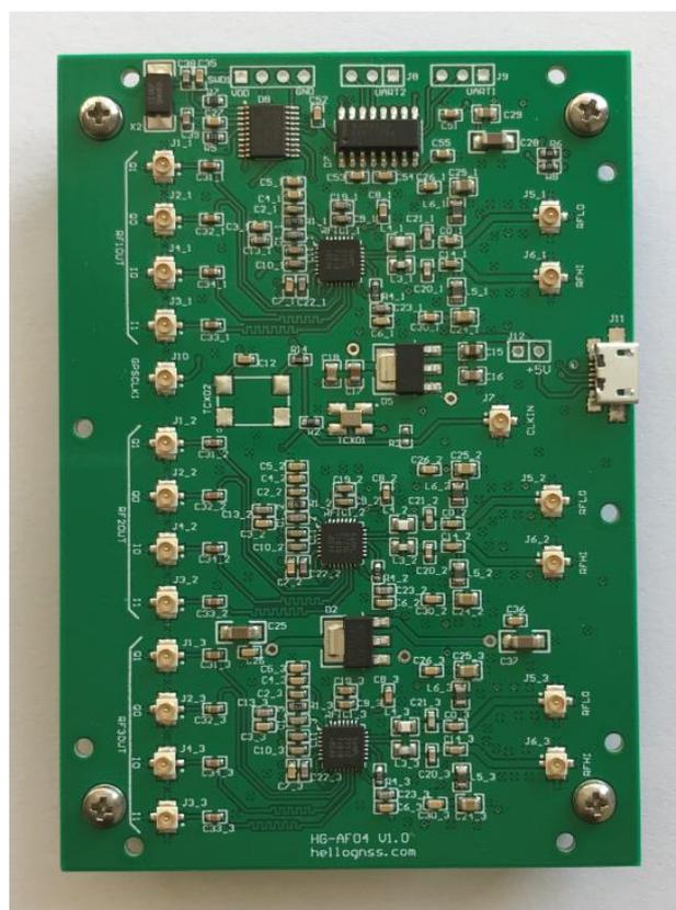
图 1 HG-AF04 双频 GNSS 射频模块
